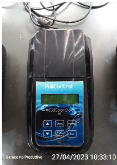
Equipamento para análise de Cloro residual
