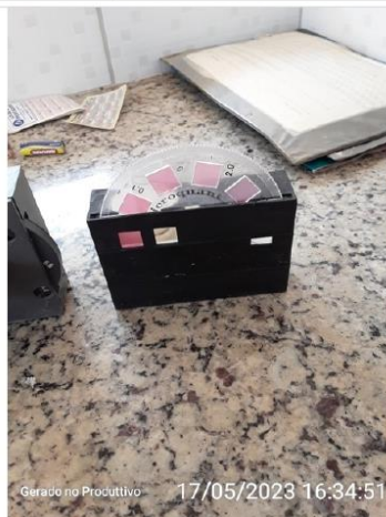
Medidor visual de Cloro residual
