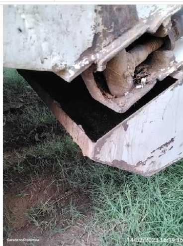
Calha coletora de chorume
