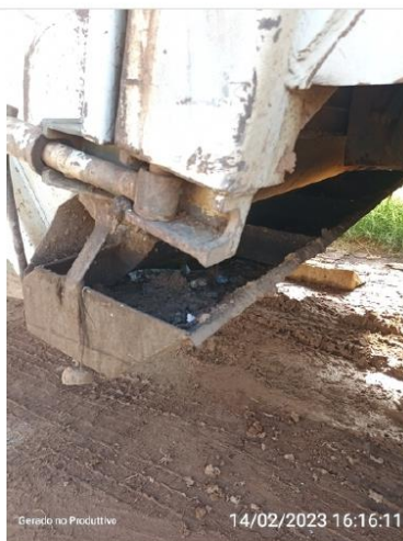
Calha coletora de chorume
