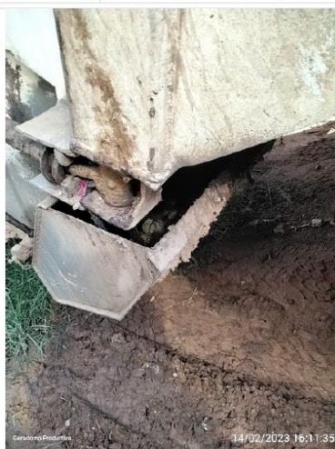
Calha coletora de chorume
