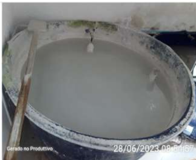
Tanque de preparo de cal
