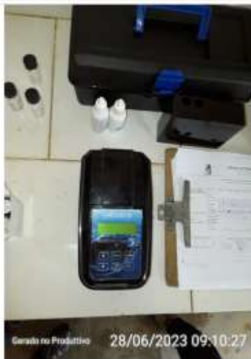
Medidor de Cloro
