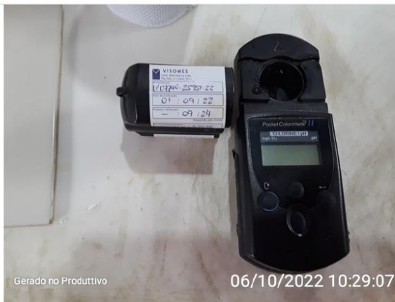
Medidor de Cloro residual e pH
