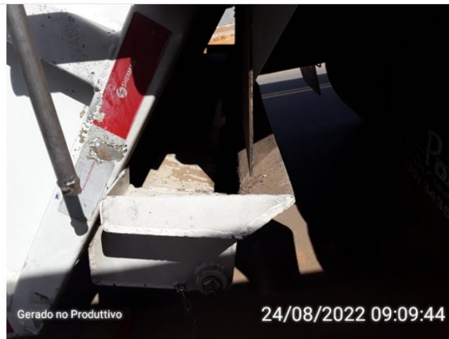
Calha coletora de chorume
