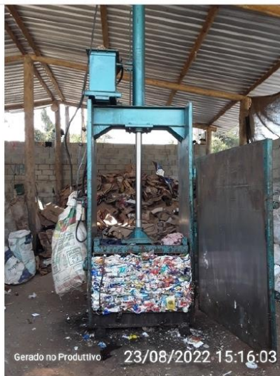
Material triado sendo prensado
