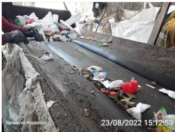
Esteira de triagem de resíduos
