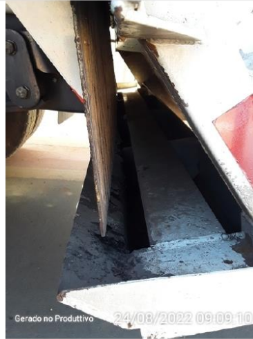
Calha coletora de chorume
