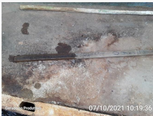
Régua utilizada para a medição da vazão
