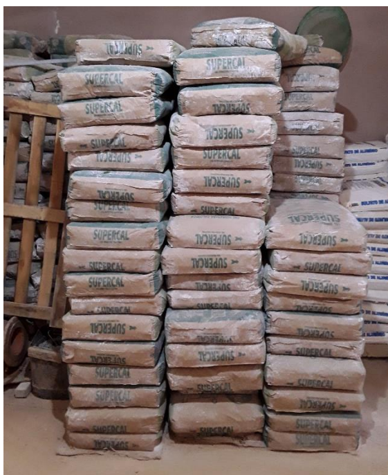
Figura 102 – Armazenamento da Cal
