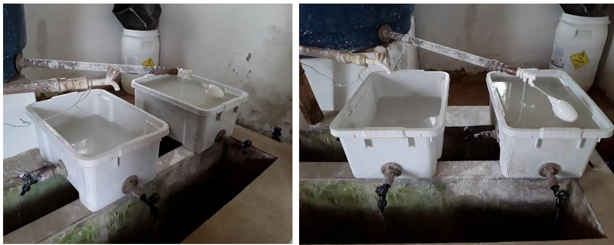
Figura 42 – Adição de sulfato de alumínio e cal
