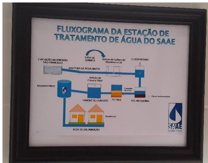
Figura 26 – Fluxograma da estação de tratamento de água
