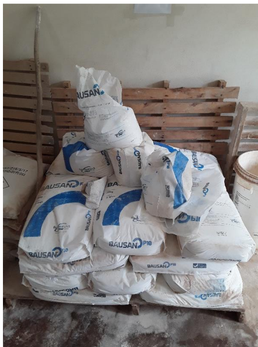
Figura 46 – Armazenamento do sulfato de alumínio
