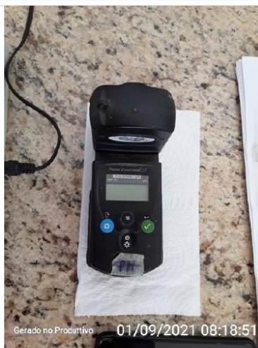
Medidor de cloro e pH
