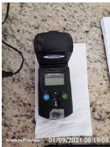
Medidor de cloro e pH
