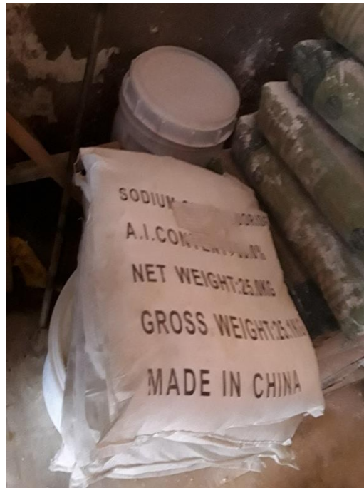
Figura 29 – Armazenamento de fluossilicato de sódio
