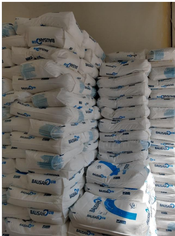
Figura 60 – Armazenamento do Hidrato de Alumínio – Bausan G10
