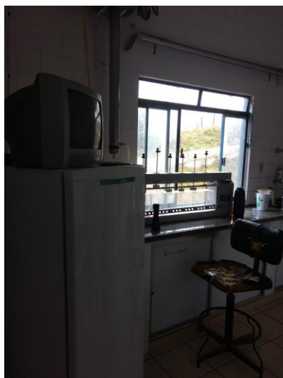
Figuras 40 e 41 – Laboratório da ETA. Detalhe para a presença de geladeira e televisão no mesmo ambiente em que são realizadas as análises.
