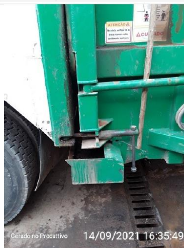
Calha coletora de chorume
