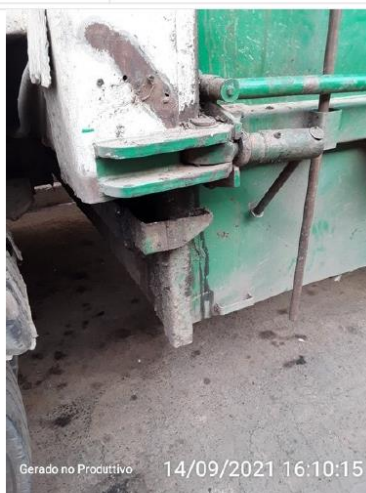
Calha coletora de chorume
