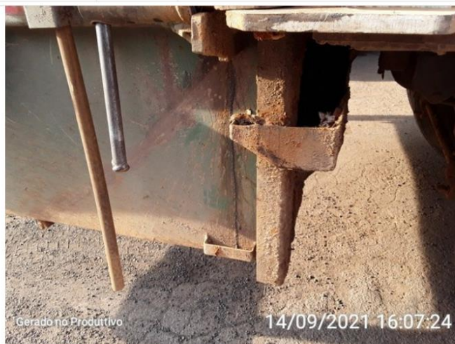
Calha coletora de chorume
