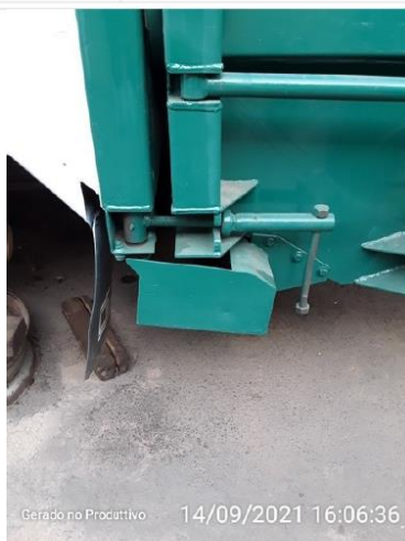
Calha coletora de chorume
