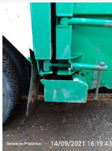
Calha coletora de chorume
