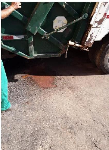
Vazamento de chorume em caminhão compactador sem calha coletora.
