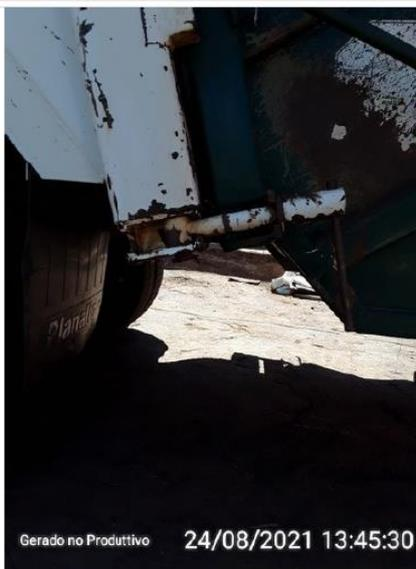
Ausência de calha de proteção do veículo.
