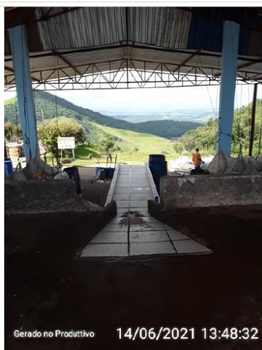
Funil de descarrega dos resíduos sólidos para segregação.
