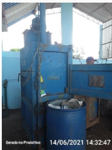
Estrutura da prensa hidráulica 2 em boas condições.
