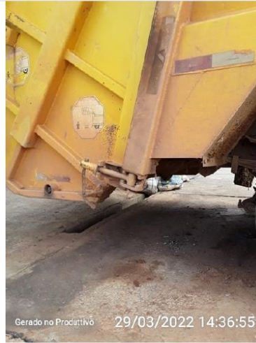
Ausência de dispositivo de coleta de chorume.
