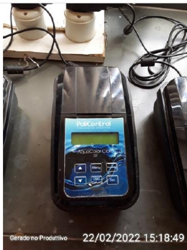
Medidor de cloro
