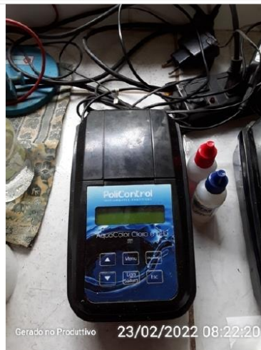
Equipamento para medição do parâmetro cloro
