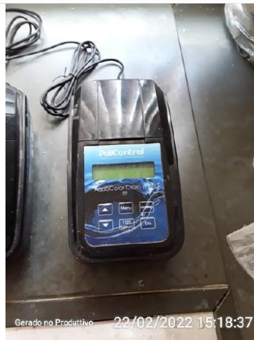
Medidor de cloro e pH
